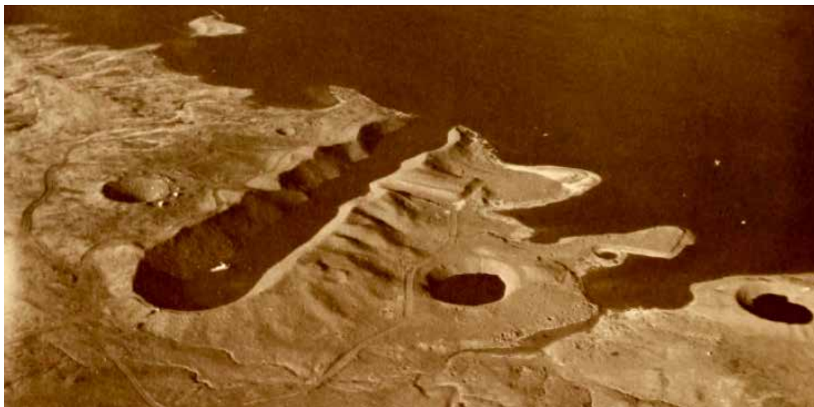
Experimento de canal excavado con explosivos químicos, Fort Peck, Montana, c. 1966-1969.
