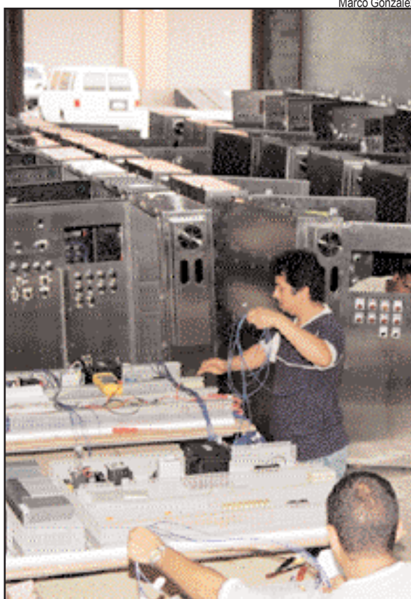
La empresa panameña Electrihogar S.A. ganó mediante licitación un contrato por B/3.3 millones para la fabricación de 129 gabinetes de control que forman parte de los nuevos sistemas de operación de las esclusas.
