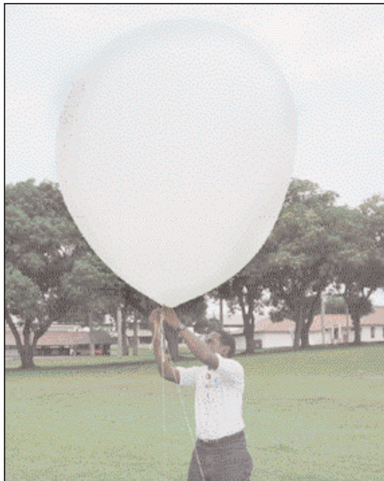
La sonda es lanzada con la ayuda de un globo. A medida que asciende, el aparato registra la presión atmosférica, temperatura, humedad y la velocidad y dirección del viento.
