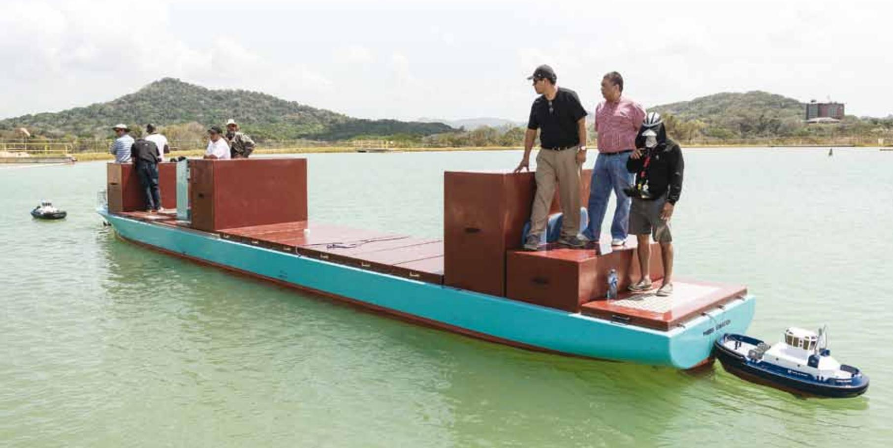
Los efectos hidrodinámicos se reproducen exactamente igual al caso en un barco real. Los efectos imprevistos como el asentamiento, efecto de aguas poco profundas, la interacción entre buques y las corrientes requerirán una reacción inmediata y adecuada.
