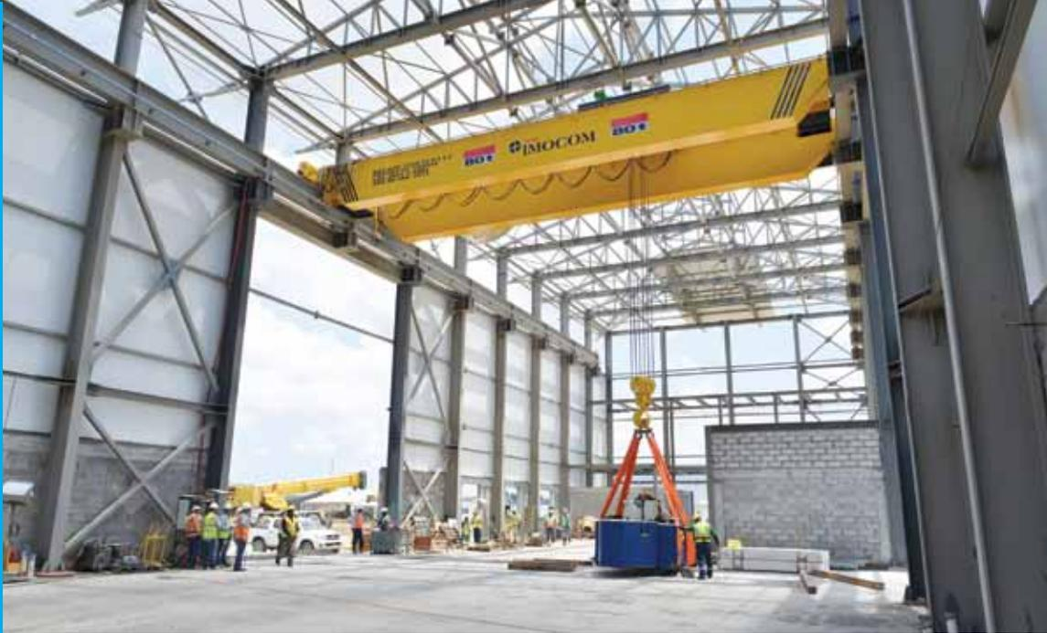
Verificación de pruebas en la grúa puente de 80 toneladas en el edificio de mantenimiento.
