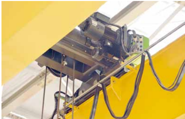
El polipasto es la parte de la grúa que realiza el levantamiento de la carga. Es un aparejo conformado por dos grupos de poleas, uno fijo y otro móvil.
