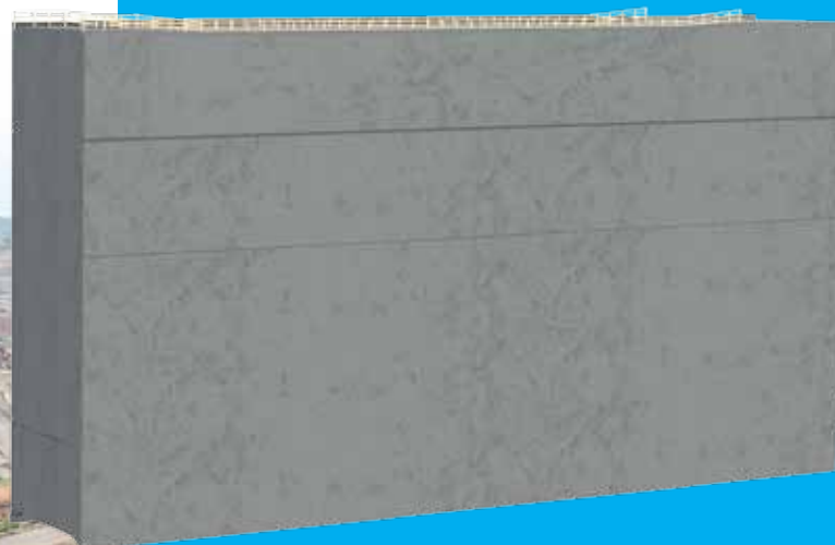
Las nuevas compuertas serán de tipo rodante, a diferencia de las actuales de tipo abisagrado, lo que facilitará su mantenimiento.
