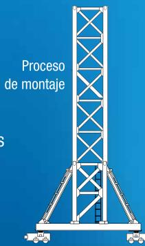
**2** Se arma la base y se levanta con una grúa telescópica para colocarle las ruedas y luego montarla sobre los rieles.
