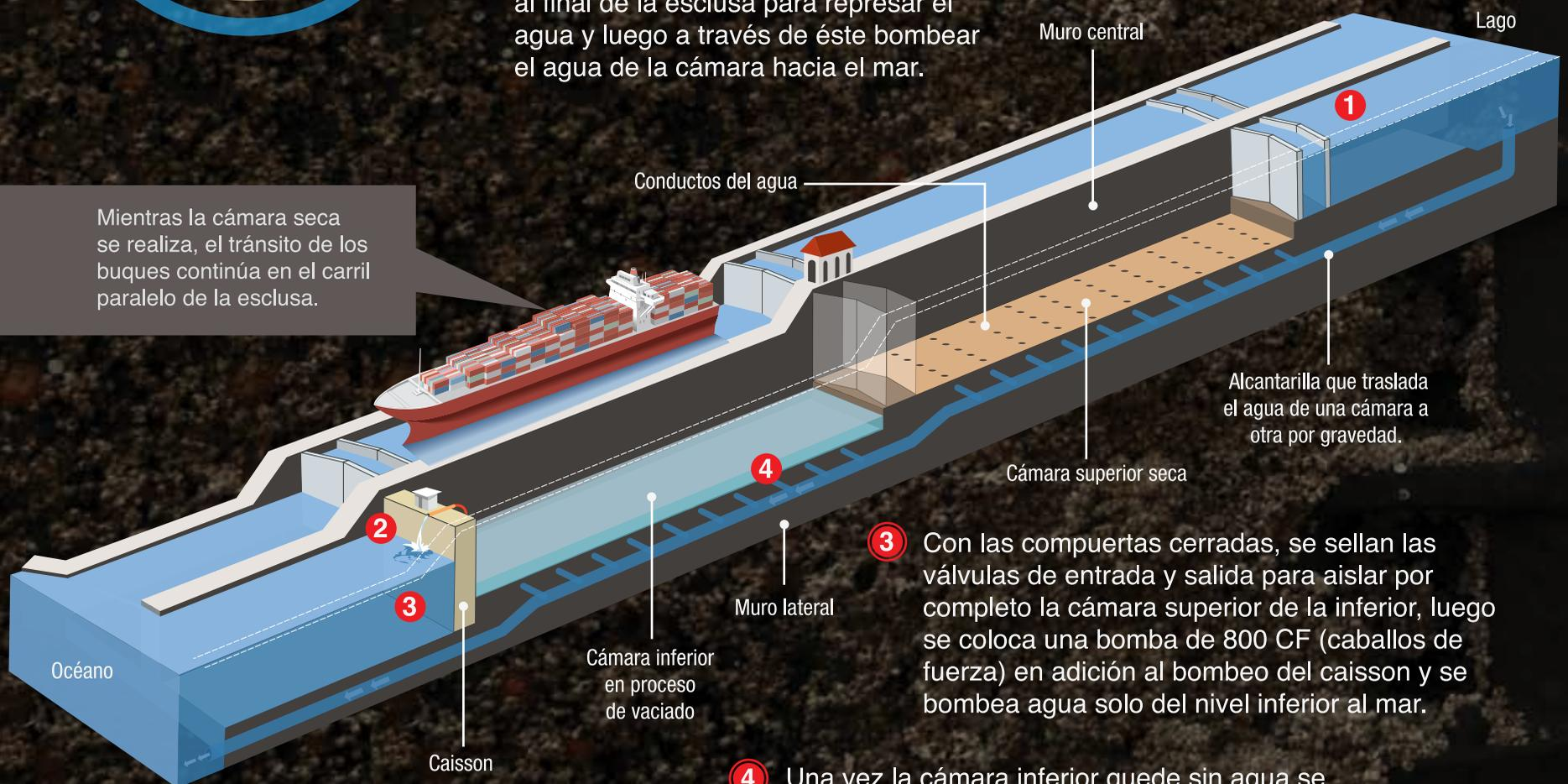
Alcantarilla que traslada el agua de una cámara a otra por gravedad.
