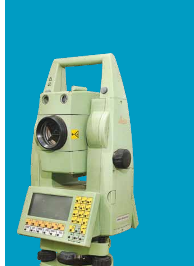
Esta estación total de la época actual se comunica a través de satélites y ondas radiales.
