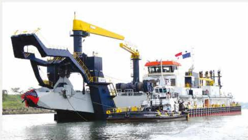
El trabajo de mantener el cauce navegable del Canal de Panamá es una labor constante de dragado. El principio es el mismo, pero la potencia ha ido en aumento. Las máquinas de la revolución industrial operaban con vapor hoy, la draga de corte y succión Quibián I forma parte de los nuevos equipos de la División de Dragado con los últimos avances tecnológicos.
